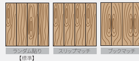
ランダム貼り
